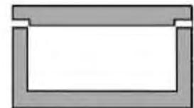
Aufliegende Deckenplatte mit Verschiebesicherung
