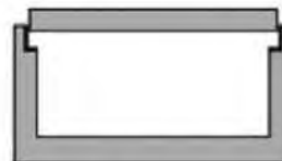
Innenliegende Deckenplatte auf einbetonierten Stahlwinkeln
